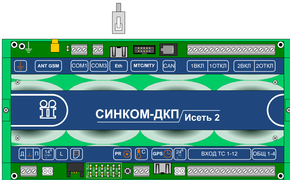
Рис. 5. Подключение канала Ethernet к контроллеру «Синком-ДКП»
